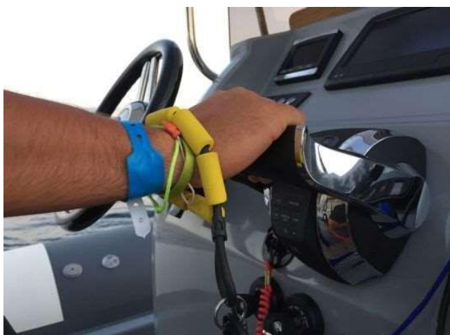
Système de coupe circuit obligatoire (revue Bateau)
